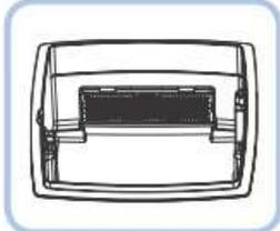
**2** Видаліть ізоляційну стрічку, встановлену під барабаном.
